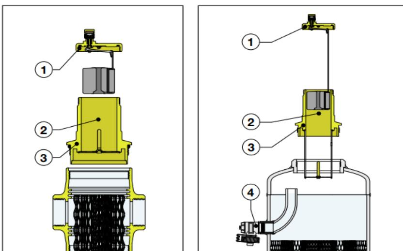
Pour la vérification de l'élément interne du séparateur-pot de décantation fileté, dévisser la chambre d'accumulation des boues (5) pour pouvoir inspecter l'élément interne, et l'ôter pour un éventuel nettoyage. La chambre d'accumulation des boues du DISCALDIRT est dotée, dans la version filetée, d'un robinet d'arrêt équipé d'un raccord à tétine et d'un bouchon (6), et dans la version à brides ou à souder, d'une vanne d'arrêt à sphère (7).
