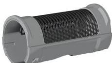
L'utilisation du filtre standard avec une maille plus grande (0,80 mm) permet de continuer la filtration de l'eau pendant le fonctionnement de l'installation sans créer de pertes de charges significatives.
